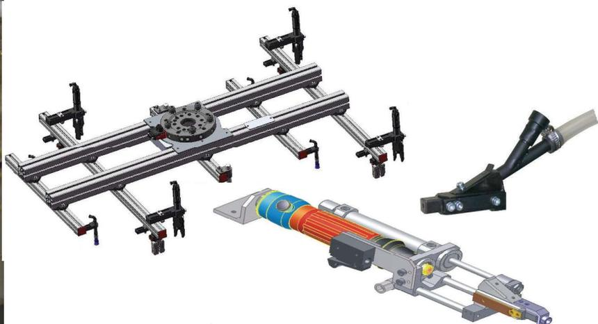
Je nach Einlegeteil konstruieren und fertigen wir teilespezifische, kompakte und robuste Greifer. Die Greifsysteme sind passend für den Roboter oder das Portal-system ausgelegt, so dass die Teile sicher und schonend gehandhabt werden können.
